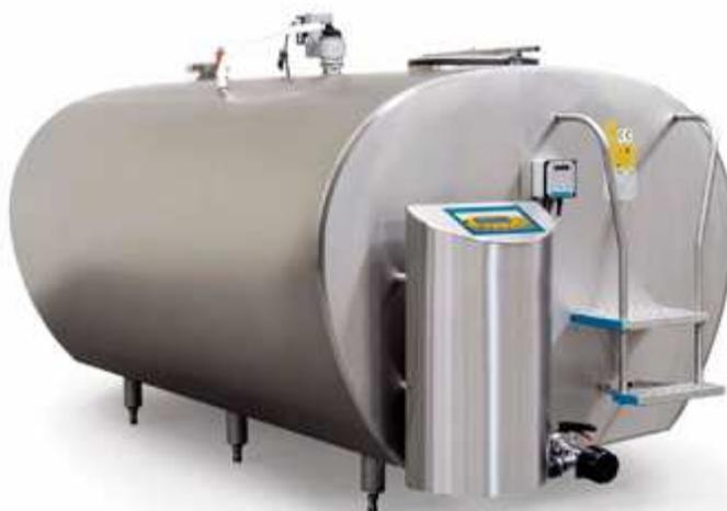
Установка молокоохладительная на два удоя закрытого типа непосредственного охлаждения. Цельный испаритель панельного типа, изготовленный методом лазерной сварки, не требует зачистки внутренней поверхности молочной емкости. Мощность компрессорно-конденсаторных агрегатов рассчитана для охлаждения молока до +4°C в течение 3 часов. Агрегаты используют безопасный для окружающей среды фреон R404A.
