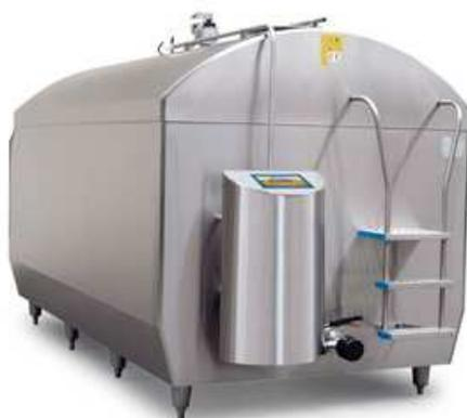
Установка молокоохладительная на два удоя закрытого типа косвенного охлаждения ледяной водой. Идеально подходит для роботизированных доильных установок. Охлаждение молока начинается с первых капель за счет «мягкого» охлаждения ледяной водой. Исключается подмораживание молока. Возможна работа в режиме аккумуляции льда в ночное время суток для экономии электроэнергии.
